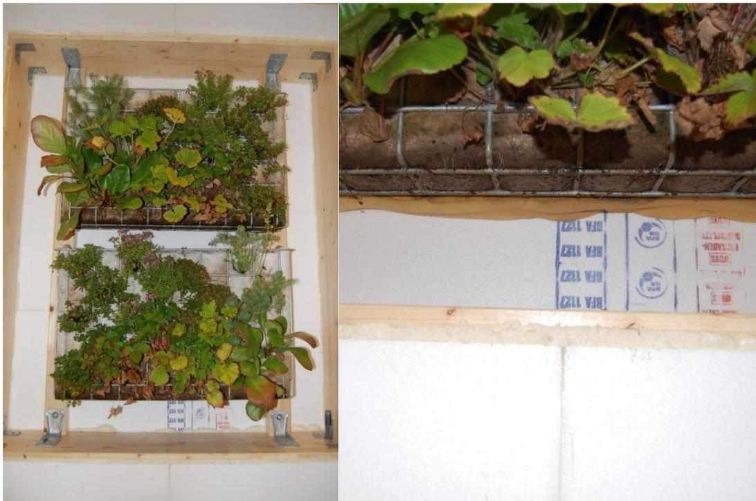
Abbildung 4: Gabionensystem in der Hot-Box mit (links) und ohne Hinterlüftung durch Abdichtung des Luftspaltes mit Schaumstoff (rechts).
