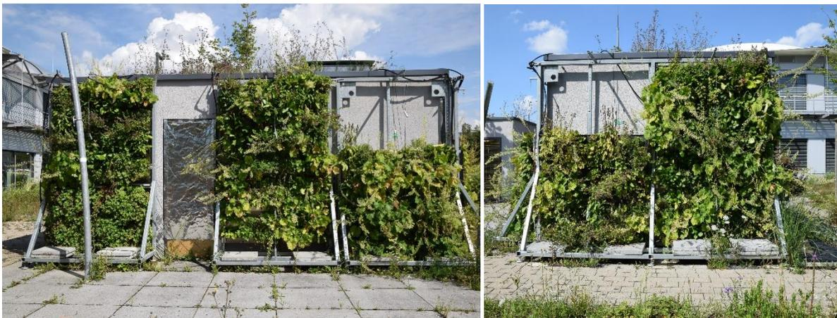
Abbildung 5: Westfassade (links) und Südfassade (rechts) mit wandgebundener Fassadenbegrünung und Referenzfeld an der Klimaforschungsstation des CAE in Würzburg.
